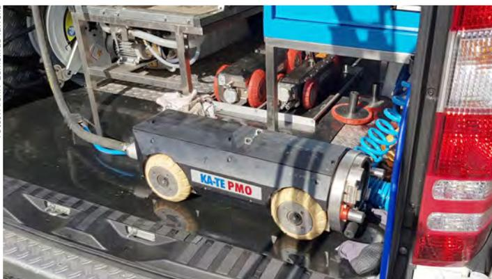
**Ka-Te Roboter der STRABAG AG Kanaltechnik**
