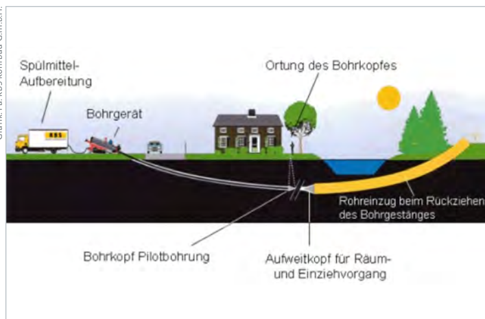
Schematische Darstellung vom gesteuerten Spülbohrverfahren (HDD)
